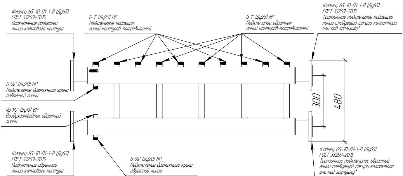
\*Пристыковке с другим коллектором для фланцевых соединений необходимо использовать сильфонный компенсатор.
